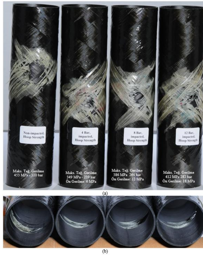
Şekil 4. Hibrit kompozit boruların statik iç basınç testi sonucu sırasıyla; darbe hasarsız ve 6, 12, 18 MPa teğetsel ön gerilme değerinde 20 J darbe enerjisiyle hasarlandırılmış numunelerde oluşan sonuç hasarının, a) dış ve b) iç görünüşleri
